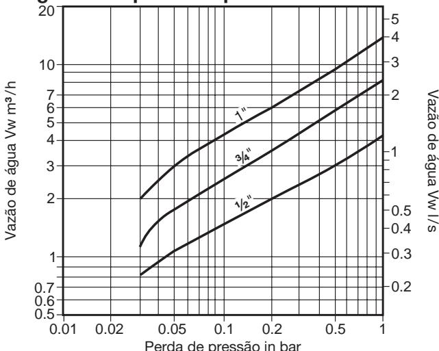
Diagrama de perda de pressão com a válvula aberta a 20°C. Os valores indicados são aplicáveis à válvulas atuadas por mola com fluxo horizontal. Com fluxo vertical, desvios insignificantes ocorrem somente dentro do range de abertura parcial. As curvas dadas no gráfico são válidas para água a 20°C. Para determinar a queda de pressão para outros fluidos, o volume de vazão de água equivalente deve ser calculado e usado no gráfico.
